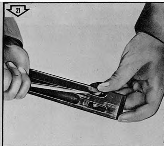
U. REMOVE COUNTER SLIDES.
